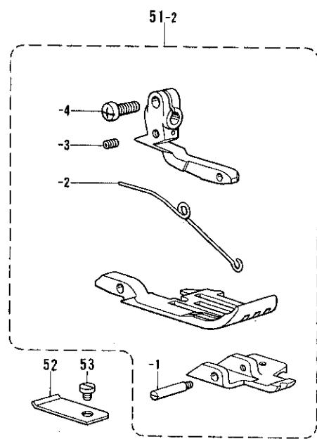
D. 押工関係/Presser foot mechanism/Stoffdrückerfuß/
