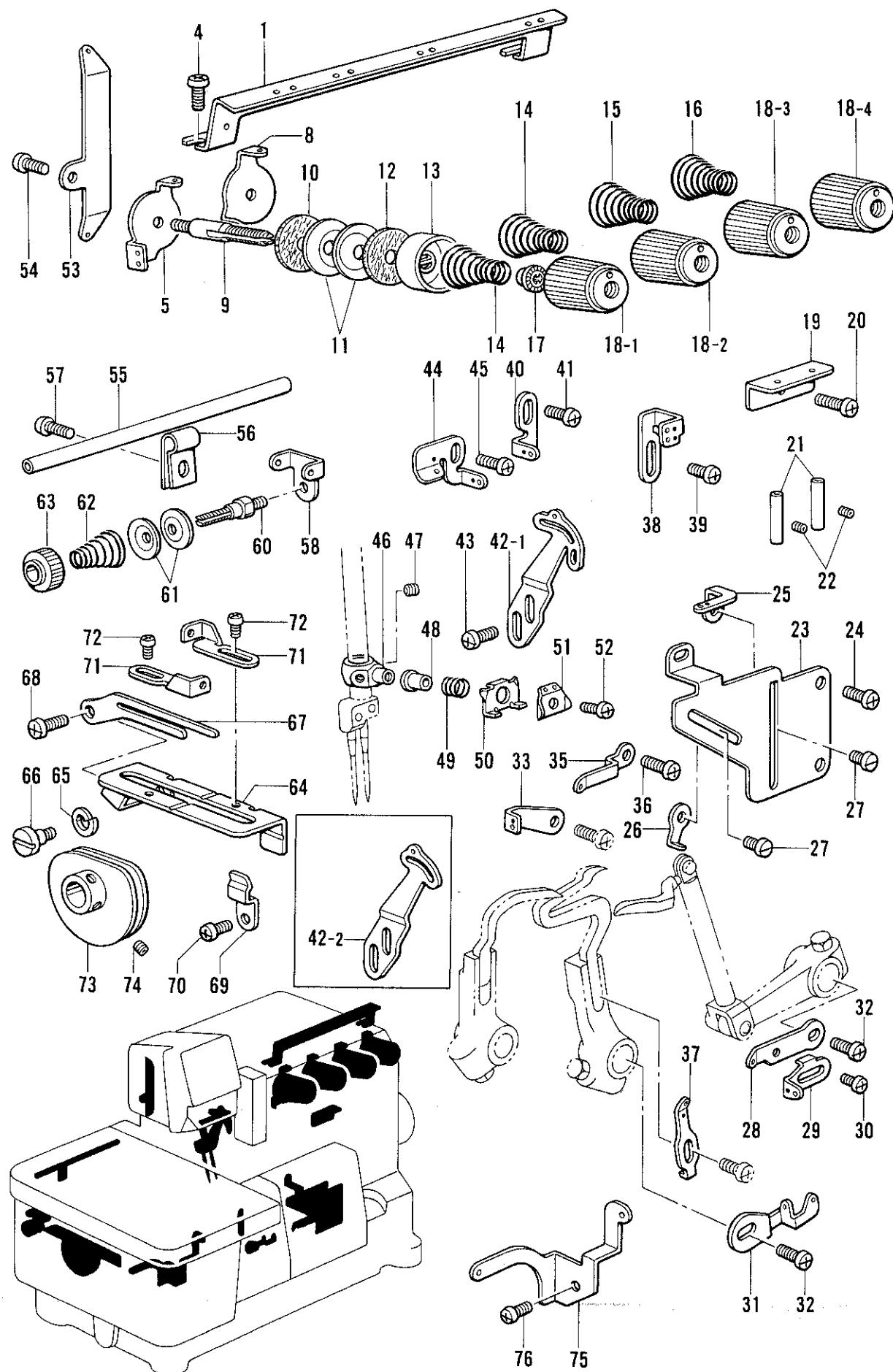
N. 糸調子関係/Thread tension/Faderspannung/
