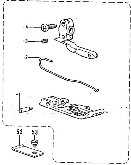
D. 押工関係/Presser foot mechanism/Stoffdrückerfuß/
