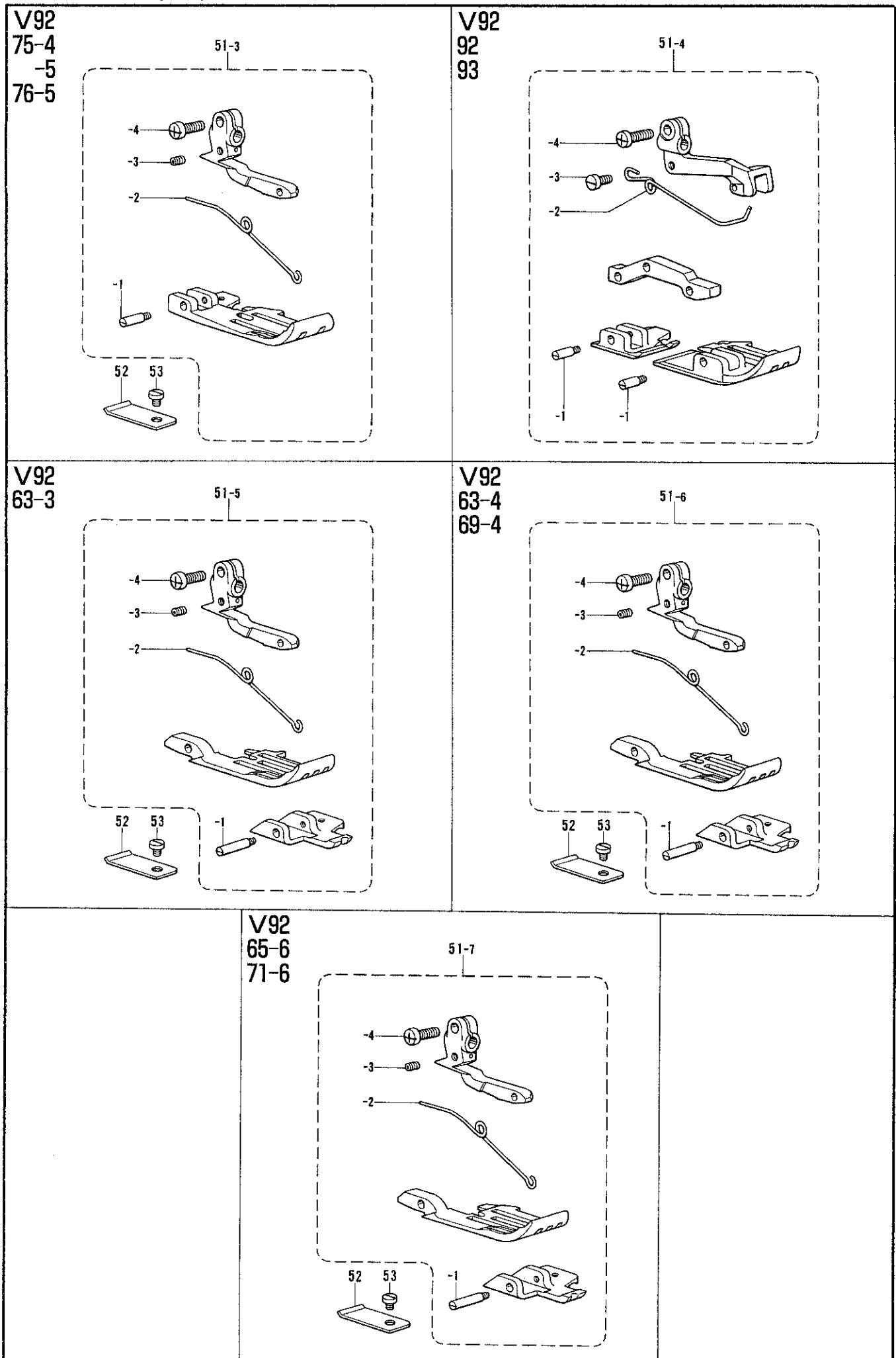
D. 押工関係/Presser foot mechanism/Stoffdrückerfuß/
