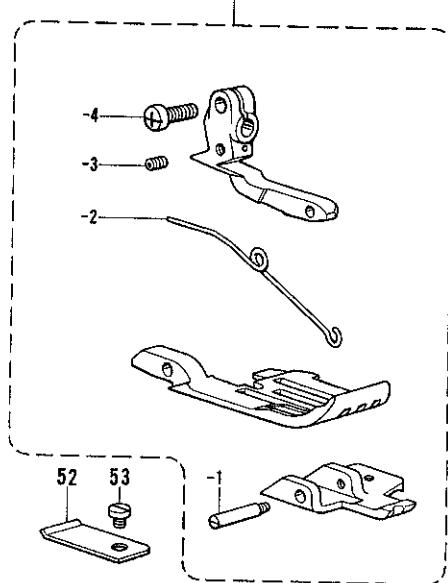
D. 押工関係/Presser foot mechanism/Stoffdrückerfuß/
