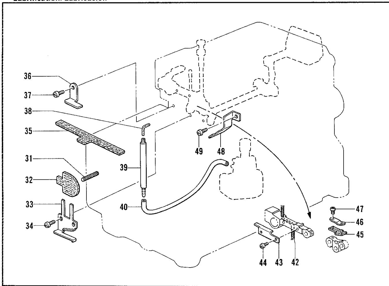
M. 針冷却装置 / Needle cooler / Nadelkühlungsvorrichtung /
