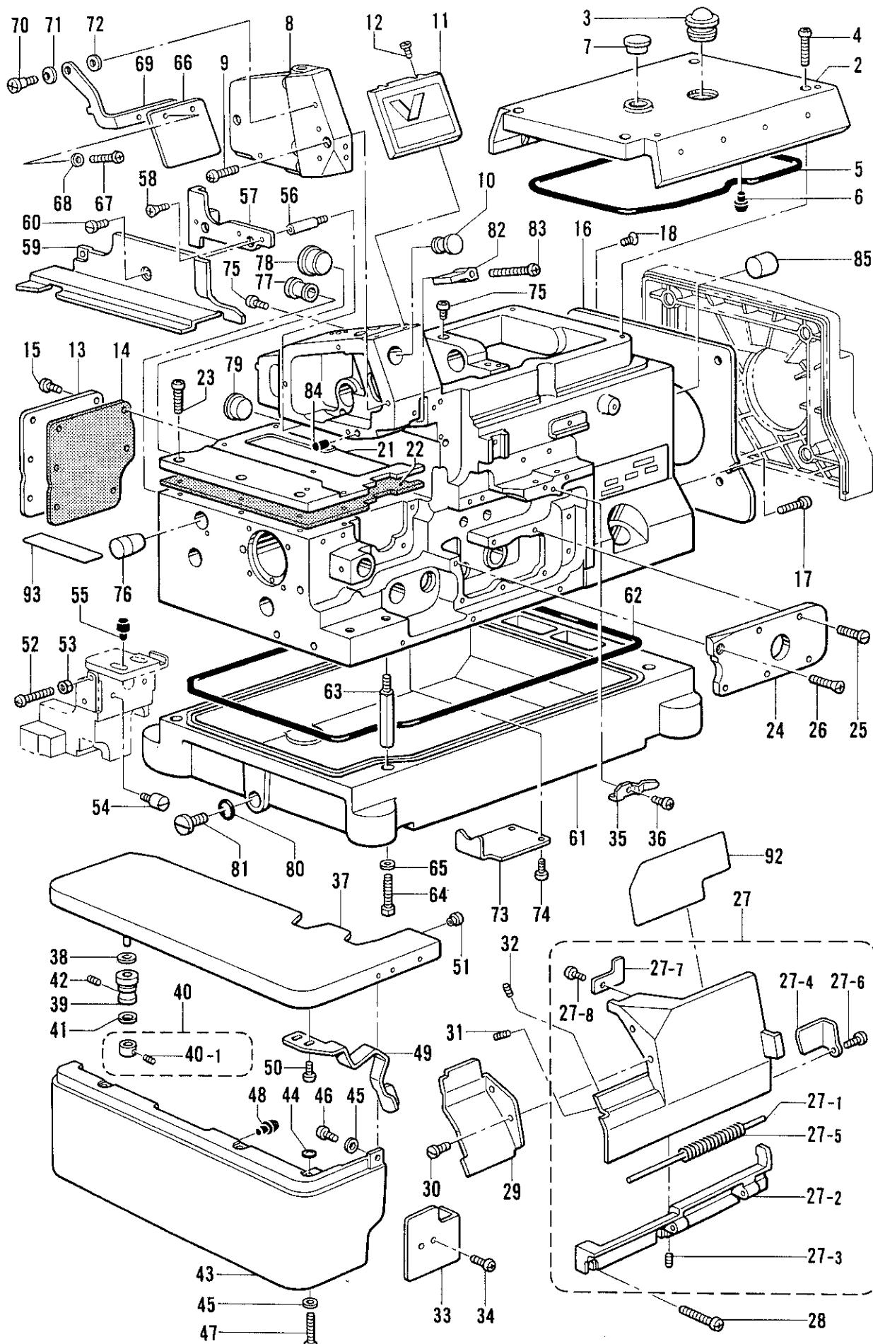
A. フレーム関係/Machine body/Maschinengehäuse/
