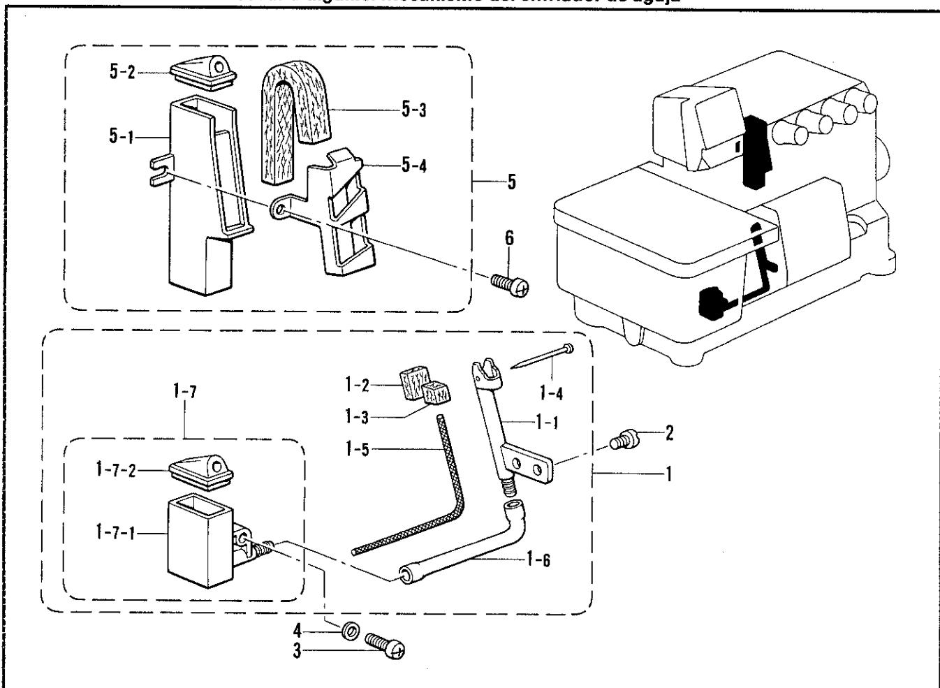
L. 給油・潤滑関係/Lubrication/Schmierung/
